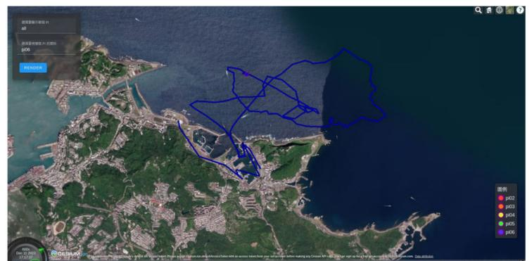
本專題開發了一款價格低廉且符合規範的電子漁網標示器，使用 Raspberry Pi Zero 2W 作為主機板，結合 GPS 模組與 LoRa 模組進行訊息傳遞，並採用運動水壺作為防水外殼，使電子漁網標示器能穩定浮於水面上。整體成本約為新台幣 4000 元，達到了開發親民且合法的目標。實驗成功完成了陸上、海岸及海上測試，證實電子漁網標示器能順利傳遞訊息並將資料回傳至 EMS，並對位置資訊進行視覺化呈現。
