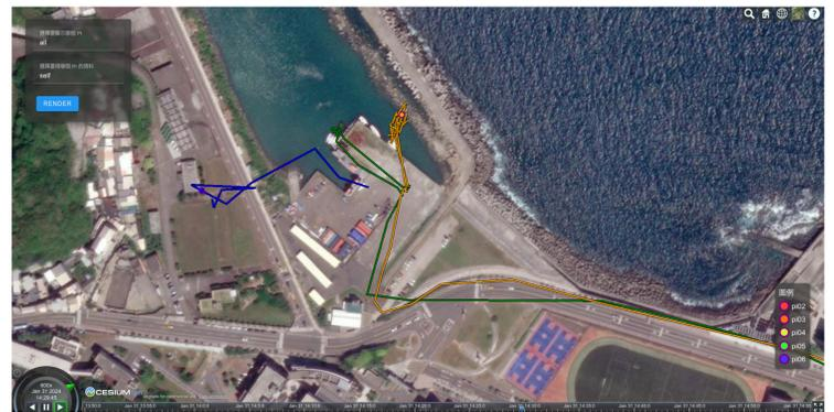
下圖為海上實驗的資料視覺化結果，擷取編號六號的電子漁網標示器所紀錄的 GPS 點位，實驗漁船從八斗子漁港出發。
